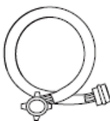
Tuyau d'arrivée d'eau (eau froide)
